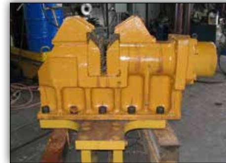
CAIXÃO PARA ADAPTADOR DA LÂMINA COM PLACA DE GIRO A 90 GRAUS.
