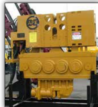
VIBRO MODELO 200 COM BRAÇADEIRA DE LÂMINA MODELO 200 EQUIPADO COM MAXILAS DE LÂMINA DUPLA.
