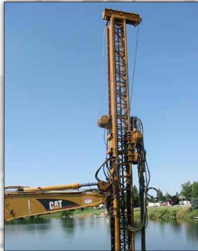
O SISTEMA DE TRILHO DE CREMALHEIRA E PINHÃO COM UMA BROCA MODELO 20 E UMA BROCA DE PERFURAÇÃO DE PERCUSSÃO.
