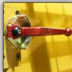
VÁLVULA DE TRANSFERÊNCIA DO TANQUE PARA COMPLETAR O FLUIDO HIDRÁULICO
