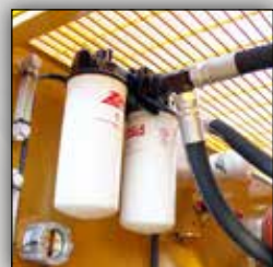
FILTRAGEM E ARREFECIMENTO HIDRÁULICO KIDNEY LOOP
